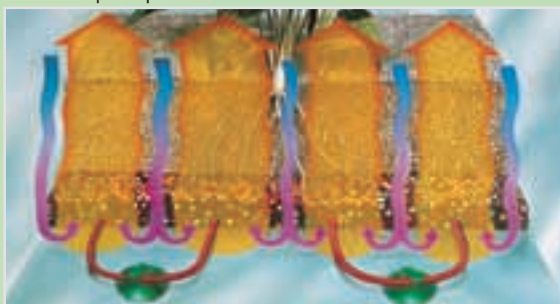
В аквариуме природный «просачивающийся» источник питательных веществ создается при помощи грунтового термокабеля Dennerle Boden-Fluter
